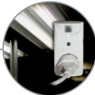
Presa della corrente telecomandata
